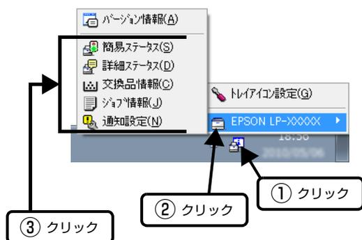
「交換品情報」をクリックすると、消耗品の寿命（残量）などが表示されます。
