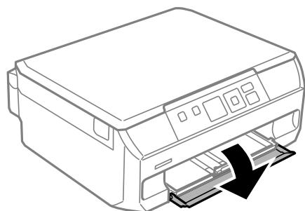
2. プリンターが動作していないことを確認して、用紙トレイを引き抜きます。
