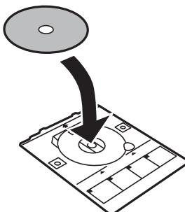
10. 排紙トレイの上の隙間に、ディスクトレイを挿入します。プリンターの「EPSON」の下に、ディスクトレイの線を合わせてください。
