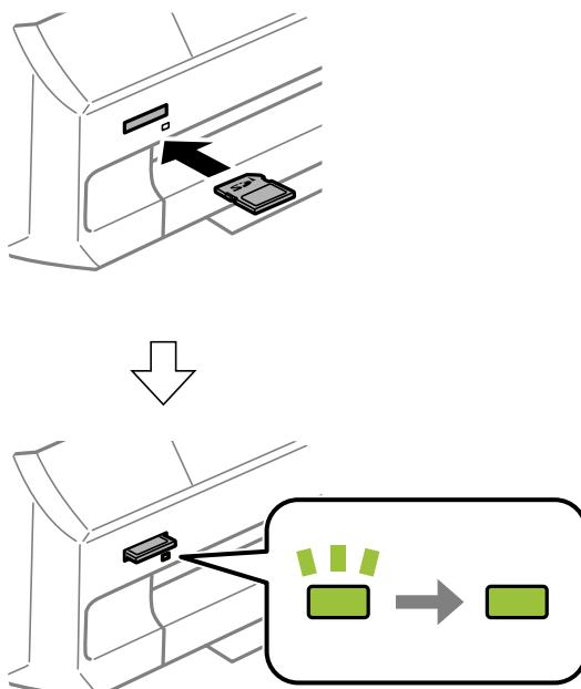
2. 印刷などが終わったら、ランプが点滅していないことを確認して、メモリーカードを取り出します。
