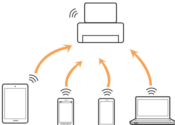
プリンターは無線LAN（Wi-Fi）と、Wi-Fi Direct（シンプルAP）の同時接続ができます。ただし、無線LAN（Wi-Fi）で接続中にWi-Fi Direct（シンプルAP）設定を開始すると、無線LAN（Wi-Fi）接続は一時切断されます。
