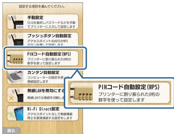
5. プリンターに表示されているPINコード（8桁の数字）を、2分以内にコンピューターからアクセスポイントに入力します。
