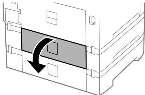
5. ドライバーでネジを取り外し、背面内部にあるカバーを取り外します。
