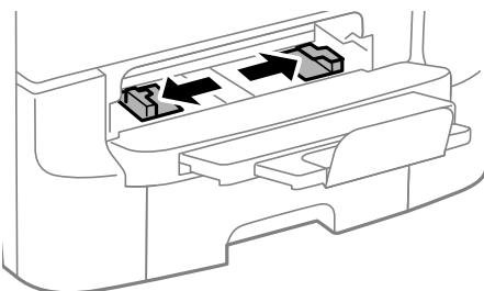
3. 印刷する面を下にして、プリンターが自動で用紙を少し引き込むまで用紙を差し込みます。
