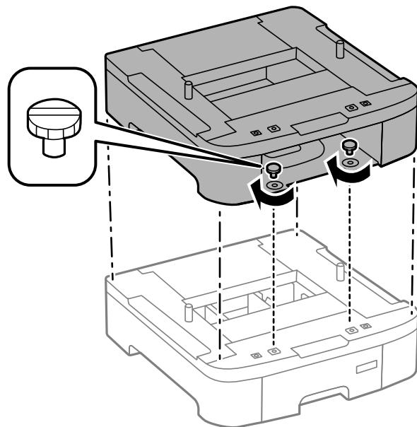
8. プリンターを、増設カセットユニットの四隅と合わせながらゆっくり下ろして置き、同梱の簡易ドライバーを使ってネジで固定します。
