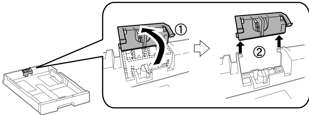
11. 新しい給紙ローラーを用紙カセットに取り付けます。
