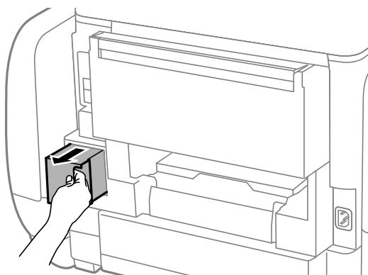
4. 使用済みメンテナンスボックスを付属の透明袋に入れ、ジッパーを閉めて密封します。
