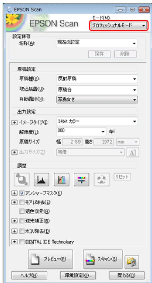
4. [原稿種]、[取込装置]、[自動露出]、[イメージタイプ]、[解像度]を設定して、[プレビュー]をクリックします。
