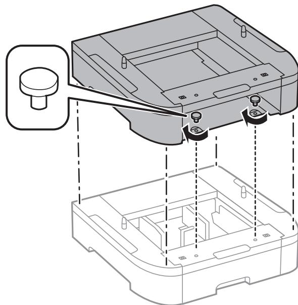
8. プリンターを、増設カセットユニットの四隅と合わせながらゆっくり下ろして置き、ネジで固定します。
