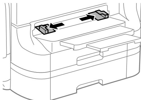
3. 印刷する面を下にして、プリンターが自動で用紙を少し引き込むまで用紙を差し込みます。
