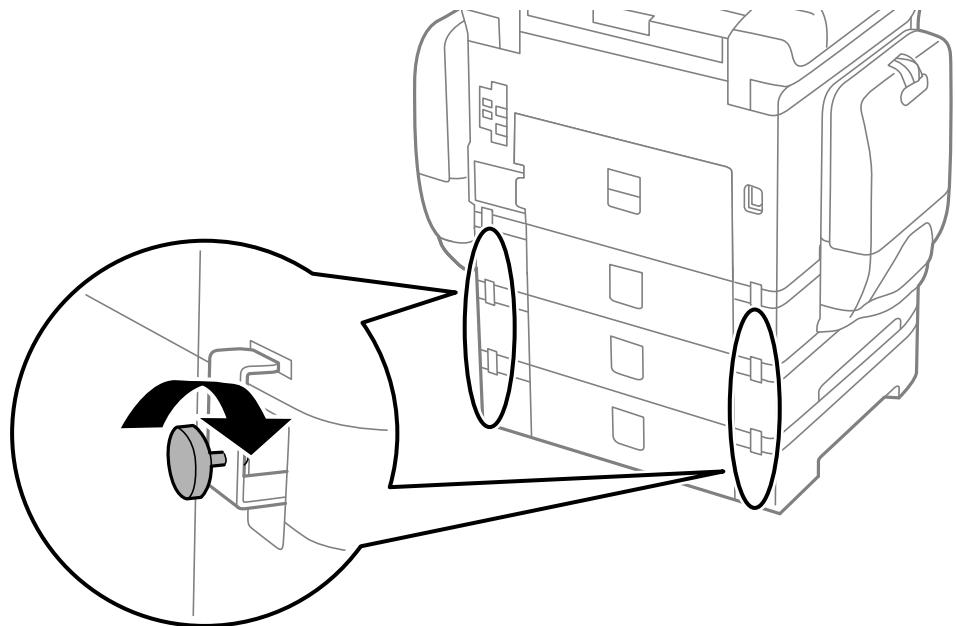
10. 増設カセットユニットにセットする用紙サイズの用紙サイズラベルをホルダーに差し込みます。
