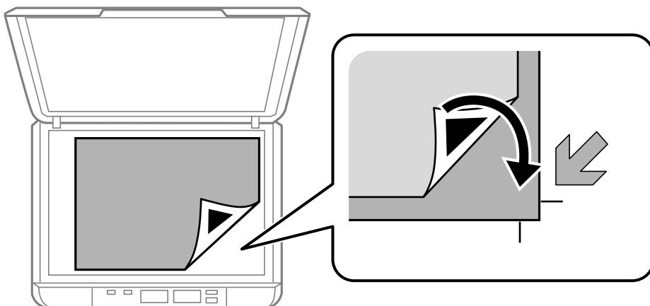
**参考** 手書き合成シートは、記入した文字が乾いていることを確認してから原稿台にセットしてください。原稿台が汚ると、汚れも一緒に合成されて印刷されます。
