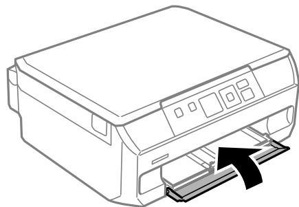
4. プリンターの底面に収納されているディスクトレイを取り出します。
