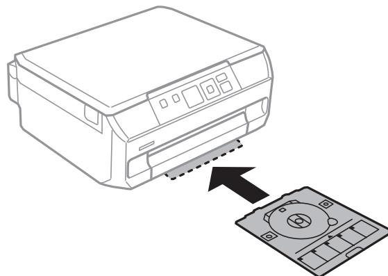
**!重要** 印刷後は必ずディスクトレイを取り出して、プリンターの底面に収納してください。プリンターにセットした状態で、電源の「入」「切」や、プリントヘッドのクリーニングなどをすると、プリントヘッドとトレイ先端が接触して故障するおそれがあります。
