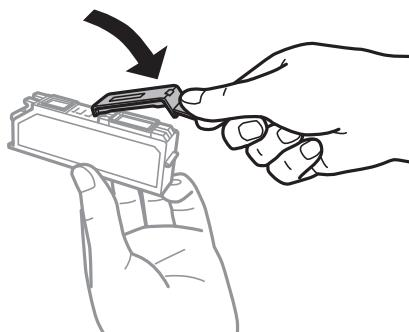
7. 新しいインクカートリッジを先端側から斜めに挿入し、【押】の部分をゆっくり押します。正しく挿入されると「カチッ」と音がします。
