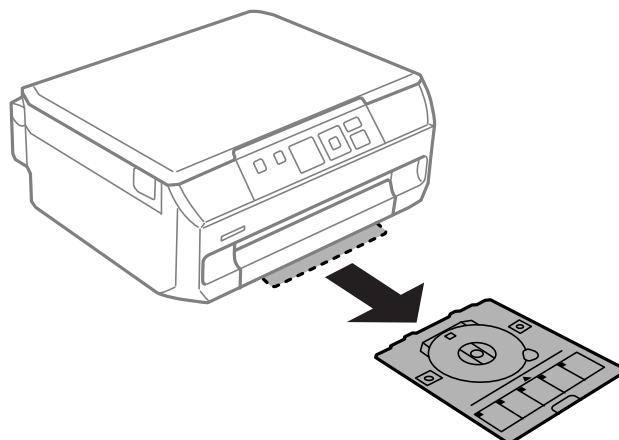
5. 印刷する面を上にして、ディスクトレイにディスクを載せます。ディスクの中央付近を押さえてセットしてください。
