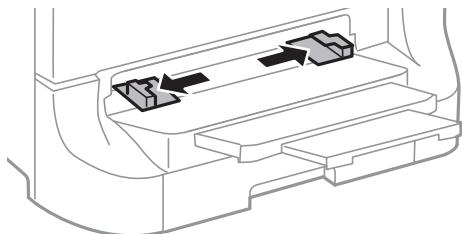
3. 印刷する面を下にして、プリンターが自動で用紙を少し引き込むまで用紙を差し込みます。
