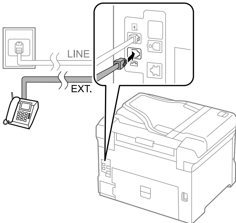
**!重要** 1つの電話回線で、ファクスと電話の両方を使用するときは、必ず外付け電話機をプリンターのEXT.ポートに接続してください。同回線にプリンターと並列で接続すると（ブランチ接続）、プリンターも電話機も正常な動作ができなくなります。
