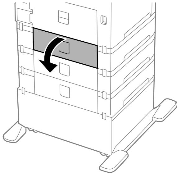
5. ドライバーでネジを取り外し、背面内部にあるカバーを取り外します。
