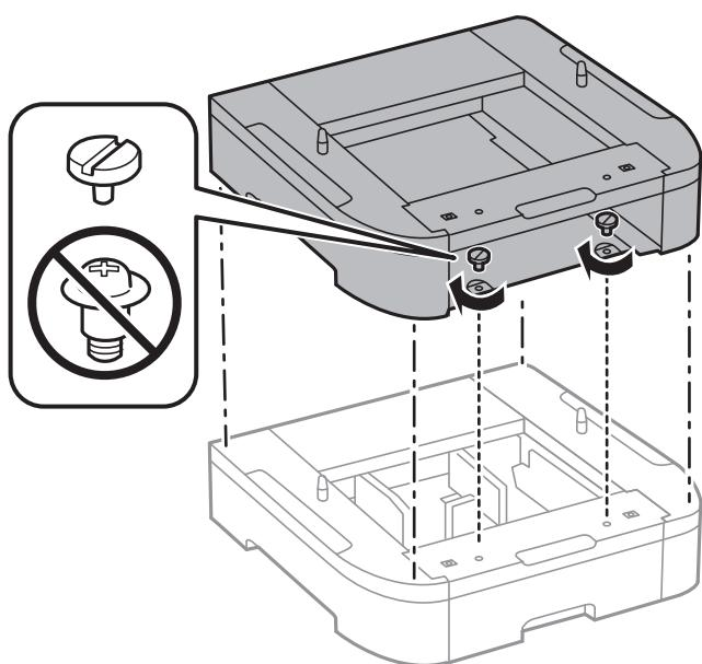
8. プリンターを、増設カセットユニットの四隅と合わせながらゆっくり下ろして置き、ドライバーを使ってネジで固定します。
