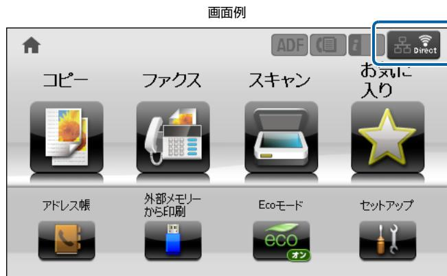
プリンターがこのアイコンになっているときは、他のネットワーク接続が中断しています。プリンターと接続されている機器との Wi-Fi 接続が切断されると、プリンターは直前のネットワーク接続に戻ります。ホーム画面のアイコンが変わることで接続の状態を確認できます。
