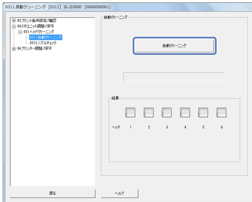
**4** 【結果】の欄に表示される各ヘッドの状態を確認します。
