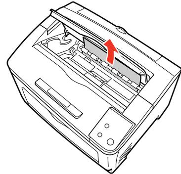
15 トナーカートリッジの取っ手を持ち、図のようにトナーカートリッジの両側にある突起を本機内部の溝に合わせて装着します。
