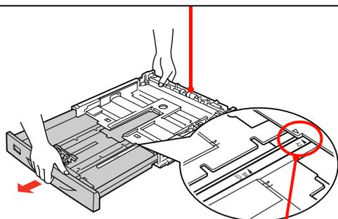
引き出し段数に合わせて、▼ マークと固定部の ◀ マークを合わせる
