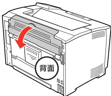
オプションの両面印刷ユニットを装着している場合は、両面印刷ユニットのカバーを開けてからカバーBを開けます。
