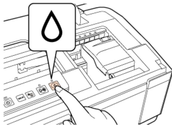
**3. インク残量確認ランプで、交換の必要なインクカートリッジを確認します。**
