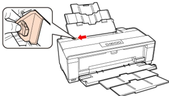
**4.** 用紙を右側に沿わせてセットし、エッジガイドを用紙の側面に合わせます。
