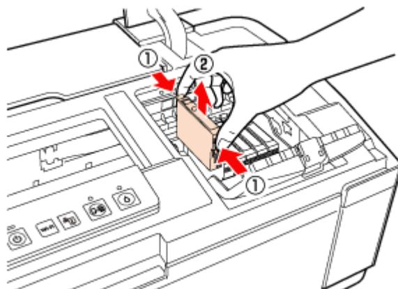
**7. 新しいインクカートリッジをまっすぐに挿入し、「押」部分をしっかり押し込んでセットします。**
