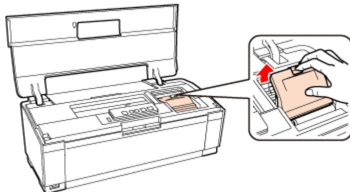
**6. 交換するインクカートリッジを取り外します。**
