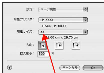
より大きなサイズの用紙が利用できないときは、プリンタードライバーの [拡大 / 縮小] 機能を使用すると、用紙サイズに合わせて印刷データを拡大 / 縮小して印刷できます。
