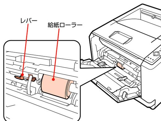
給紙ローラーが外れたときは、以下を参照してローラーを取り付けてください。
