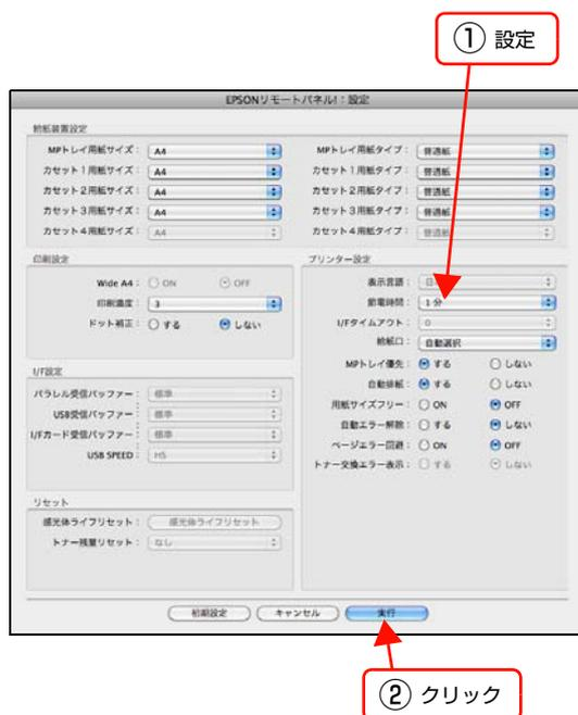
最後の印刷が終了してから、指定した時間（初期値 15分）が経過すると節電状態になります。節電状態のときは、印刷するデータを受け取ると、まず数秒間ウォーミングアップを行ってから、印刷を開始します。
