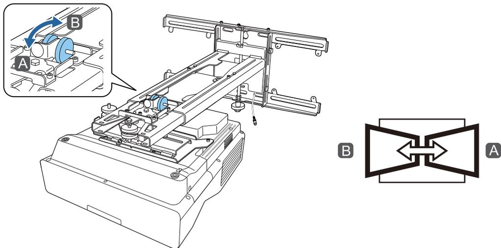
5 設置ガイド内 ③ のダイヤルを回して上下チルトを調整する
