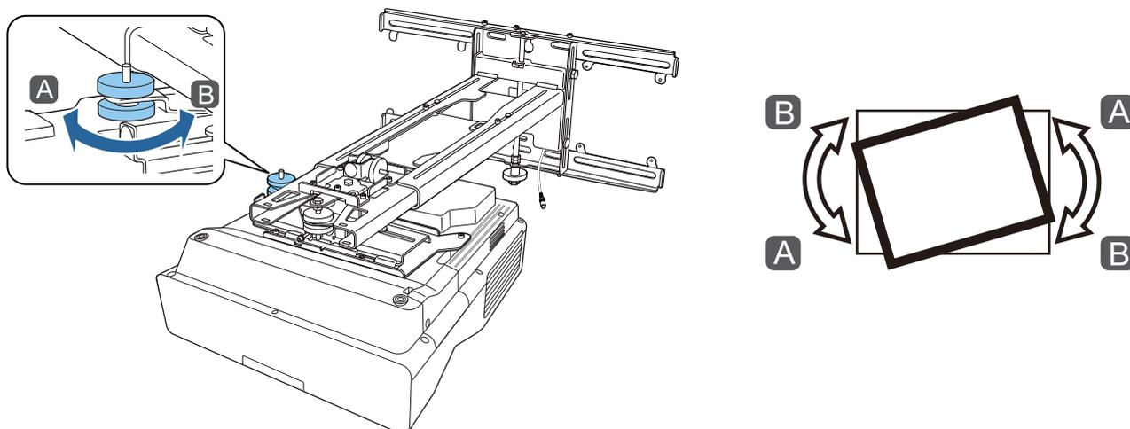
4 設置ガイド内 ② のダイヤルを回して水平回転を調整する
