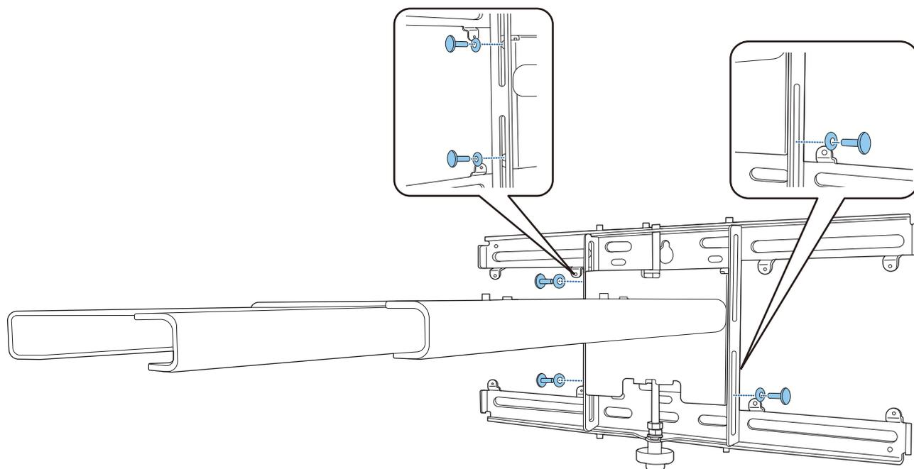
6 ラチェットレンチ（17mm）で六角軸の下部を回して、ウォールプレートとセッティングプレートの目印の位置を合わせる
