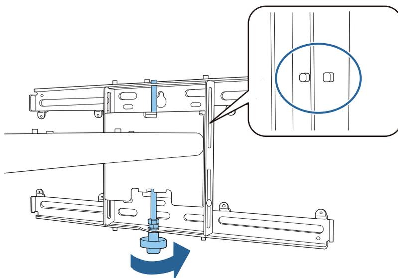
7 M6ボルト（1本）で、セッティングプレートの位置を固定する
