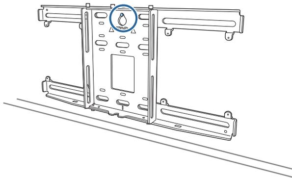
7 手順4であけた穴を使って、ウォールプレートを市販のM10または3/8インチ x 60mmアンカーボルトで固定する
