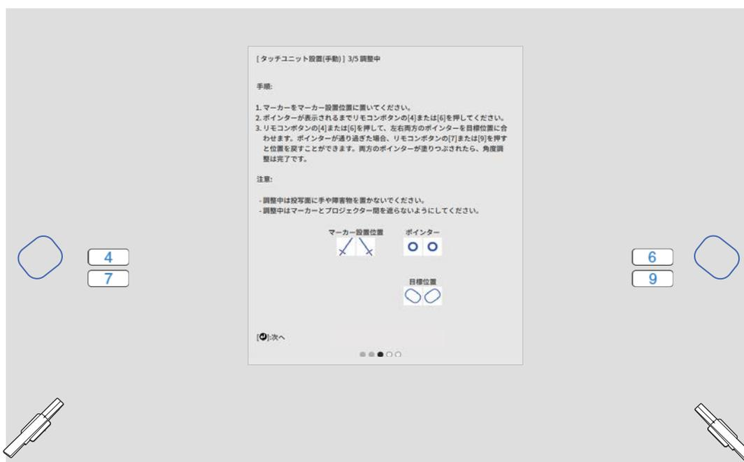
**7** 投写画面の左側にポインターが表示されるまで、リモコンの【4】ボタンを押す
