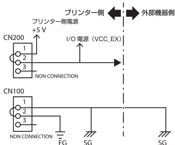
I/O 電源 (VCC\_EX)/SG 分離時
