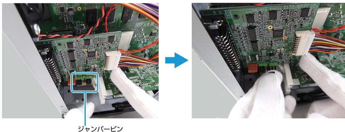
ジャンパーを設定したら、以下の手順でカバーを取り付けます。
