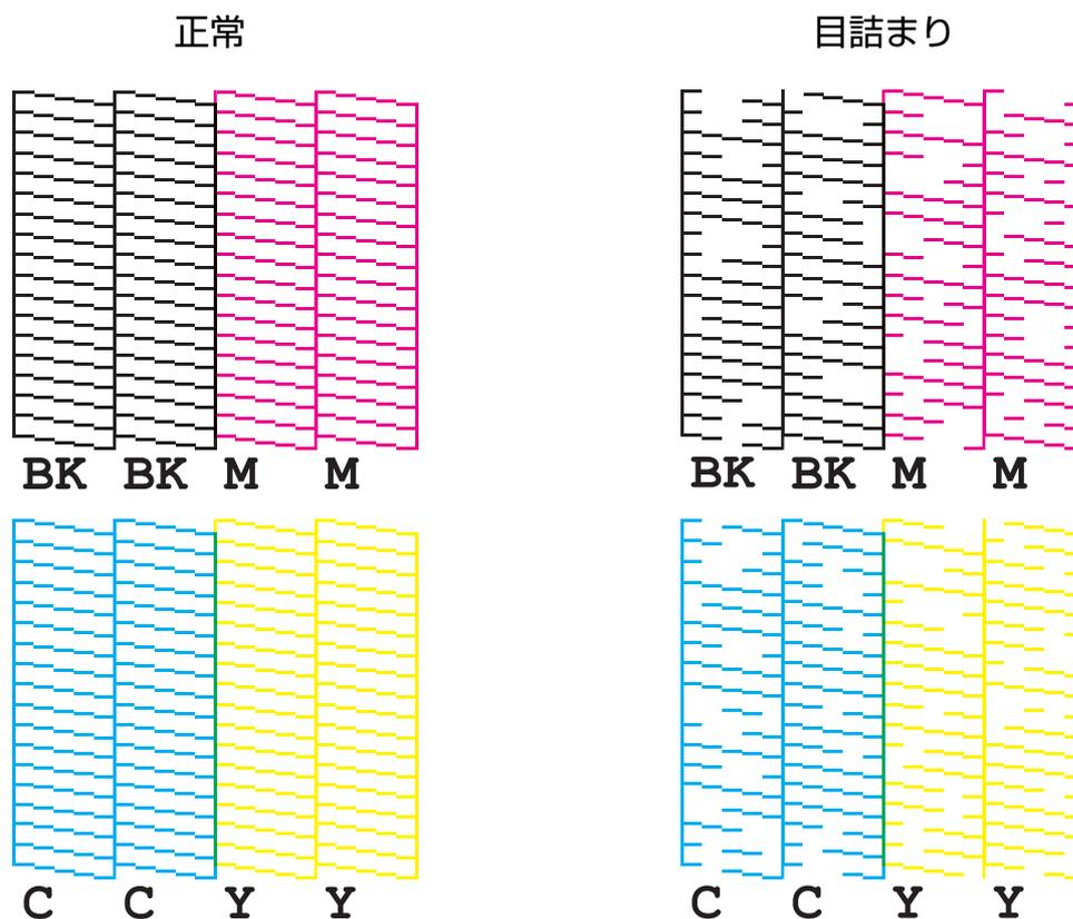
ノズルが目詰まりしているときはプリントヘッドのクリーニングをしてください。プリントヘッドのクリーニングを実行してもノズル抜けが改善しないときは、強力クリーニングを行ってください。以下の手順でプリントヘッドのクリーニングができます。
