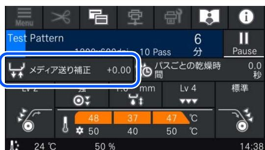
印刷時調整画面になっていないときは、ホーム画面の **[戻]** (画面切り替え) を押します。
