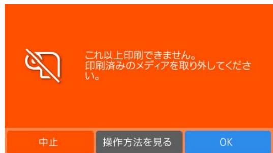
画面内の「操作方法を見る」を押すと、パネルの画面で作業手順を見ながら終了したメディアの紙管と巻き取ったメディアを取り外すことができます。画面の手順に従って作業してください。
