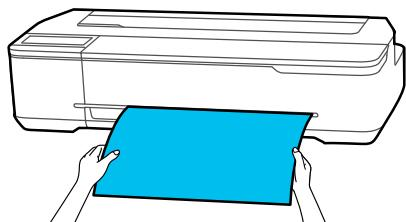
印刷後の用紙は後端が本機に保持された状態で止まります。手で取り外す前に次の印刷を開始すると自動で落下します。
