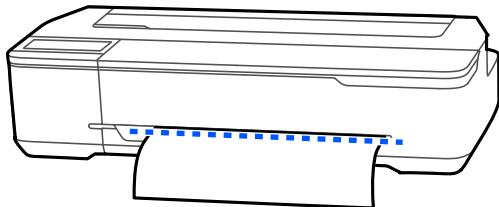
後端余白より内側に切り取り線の印刷をすることはできません。用紙の移動が終わったら
