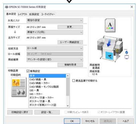
[用紙設定] を確認して、[印刷品質] を設定します。
