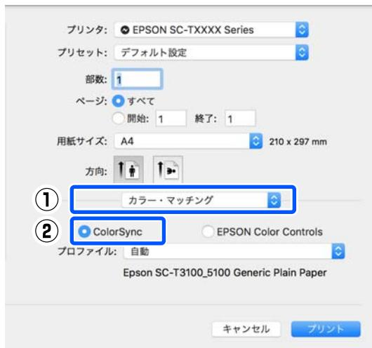
現在選択されている用紙種類\*に対応したプリンタープロファイルが自動的に指定され、プロファイル欄の下に表示されます。プロファイルを変更したいときは、[プロファイル] のプルダウンメニューから目的のものを選択します。
