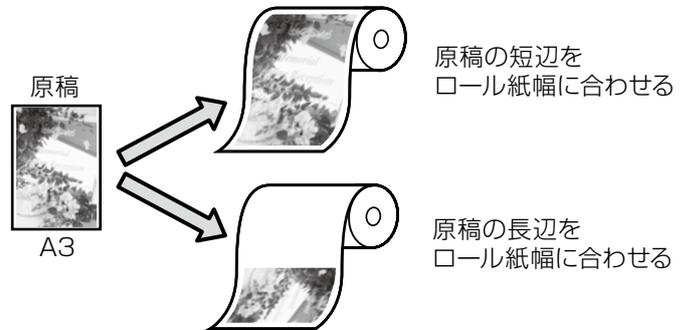
【出力サイズ】で【ロール紙幅に合わせて】を選択し、ロール紙幅に短辺を合わせるか、長辺を合わせるか選択します。
