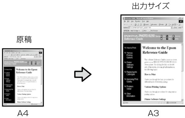
【出力サイズ】で【出力サイズに合わせる】を選択し、出力サイズを選択します。
