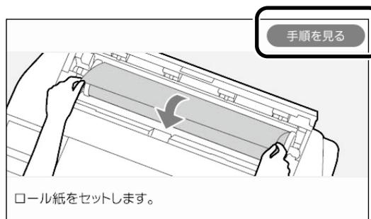
ホーム画面で【用紙をセットしてください】または【印刷可能】が表示されているときは、単票紙カバーを開けて用紙のセットを開始できます。ただし単票紙は、用紙セット後に 2 で【単票紙（1枚）】を選択してください。用紙が検知されません。
