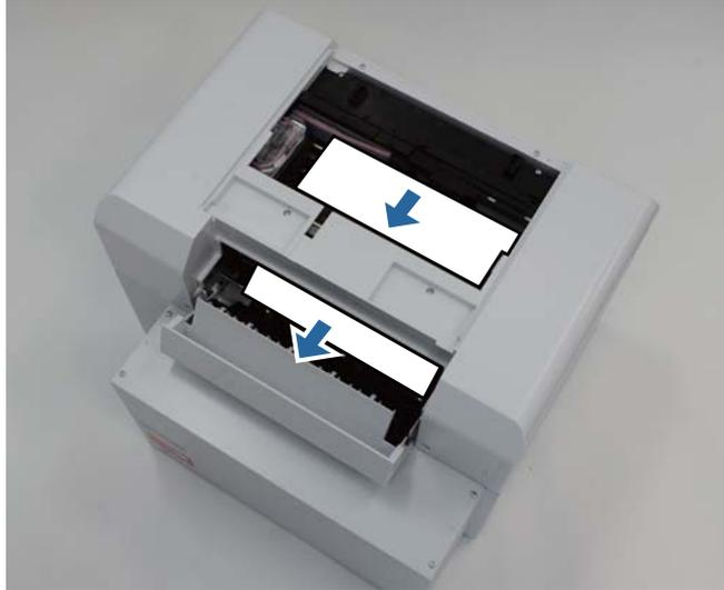
**7** プリントヘッドユニットを手で動かし、ペーパーを後方へ引き抜きます。
