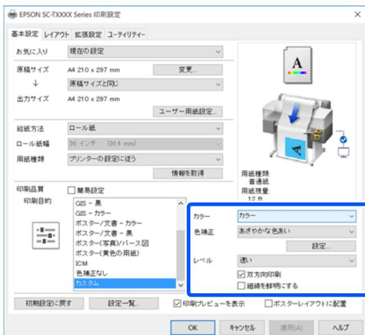
5 必要に応じて [設定] をクリックし、ガンマ、明度、コントラスト、彩度、カラーバランスなどを調整します。
