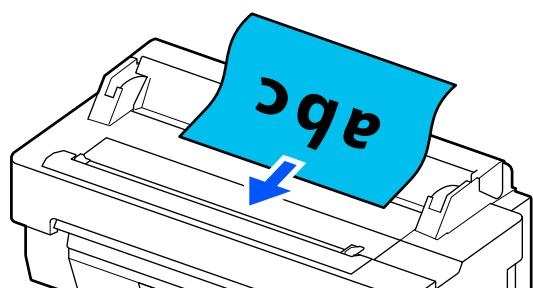
原稿の先端が給紙口の奥に突き当たると、自動的に読み取り開始位置まで給紙されます。自動給紙が始まつたら手を放し、原稿の引き込み動作を妨げないでください。音が鳴つたら給紙完了です。
