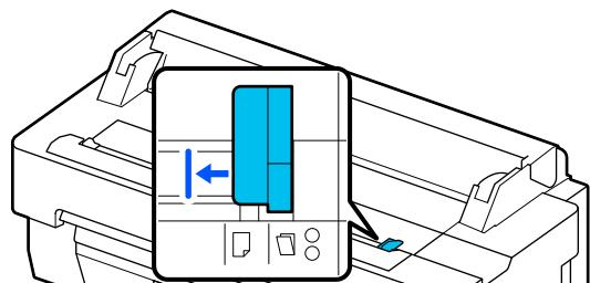
キャリアシートを使ってスキャンするときは、原稿ガイドを図で示した位置に合わせます。
