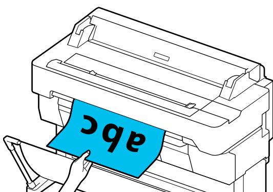
原稿の取り外しが完了すると、印刷を開始します。
