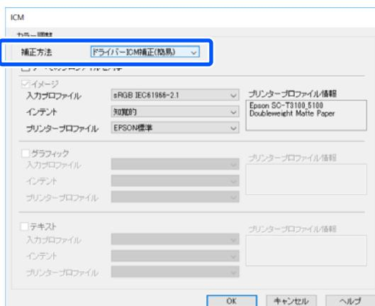
[ドライバー ICM 補正(詳細)] を選択すると、写真などのイメージデータ、グラフィックデータ、テキストデータごとにプロファイルとインテントが指定できます。
