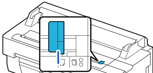
原稿のセット位置が合っているときは、以下の項目を確認してください。それでも給紙がうまくできないときは、[原稿サイズ] または [読み取りサイズ] を [自動検知] から定形サイズ等に変更してください。
