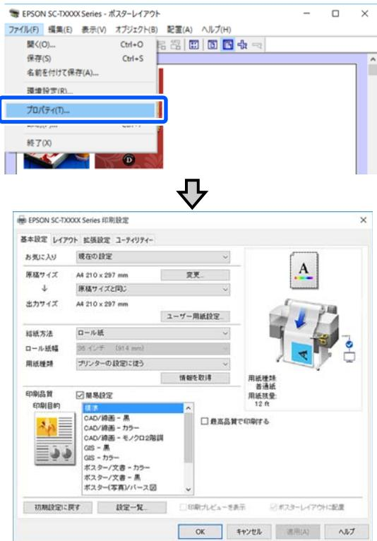
【用紙設定】を確認して、【印刷品質】を設定します。
