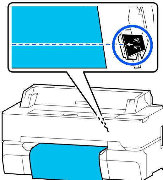
後端余白より内側に切り取り線の印刷をすることはできません。用紙の移動が終わったら
