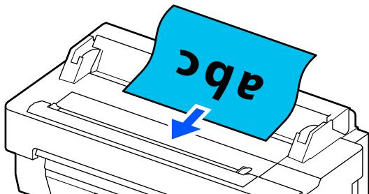
原稿の先端が給紙口の奥に突き当たると、自動的に読み取り開始位置まで給紙されます。自動給紙が始またら手を放し、原稿の引き込み動作を妨げないでください。音が鳴ったら給紙完了です。
