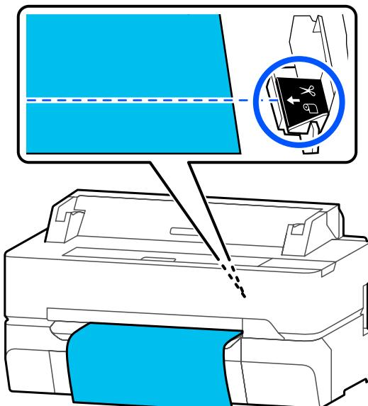
後端余白より内側に切り取り線の印刷をすることはできません。用紙の移動が終わったら
