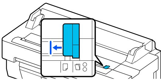
キャリアシートを使ってスキャンするときは、原稿ガイドを図で示した位置に合わせます。
