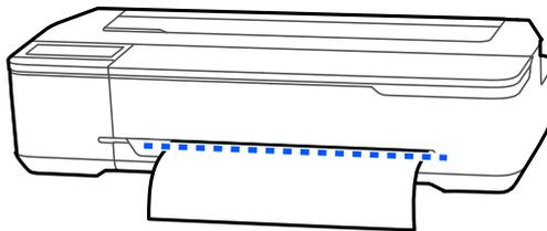
後端余白より内側に切り取り線の印刷をすることはできません。用紙の移動が終わったら
