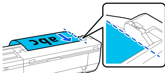
先端が給紙口の奥に突き当たると、自動的に原稿が読み取り開始位置まで給紙されます。自動給紙が始まったら手を放して、原稿の引き込み動作を妨げないでください。音が鳴ったら給紙完了です。
