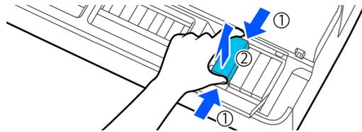
インク排出後にインクカートリッジを再装着します。取り外したインクカートリッジはインク供給孔部を下にするか横にして近くに置いてください。
