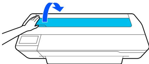
**3** 用紙の印刷する面を手前にして、用紙右端を右端の刻印線に、左端を用紙サイズの刻印線に合わせます。
