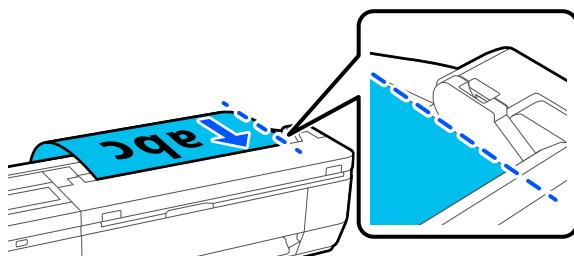
先端が給紙口の奥に突き当ると、自動的に原稿が読み取り開始位置まで給紙されます。自動給紙が始またら手を放して、原稿の引き込み動作を妨げないでください。音が鳴ったら給紙完了です。
