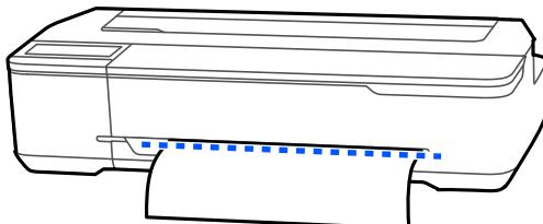
後端余白より内側に切り取り線の印刷をすることはできません。用紙の移動が終わったら
