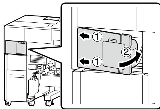
以降、本機の電源が入っている状態でこのカバーを開けないでください。電源が入っている状態でこのカバーの内部に手が触ると静電気による誤動作の原因となります。
