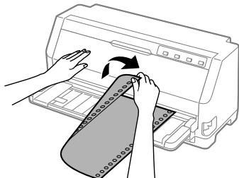
次の印刷を行うと、連続紙が印刷開始位置まで自動的に戻って印刷が始まります。
