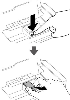
**7** 新しいカートリッジを先端側から斜めに挿入する
