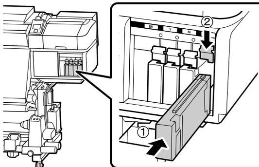
本機とインクカートリッジのラベルの色を合わせて全スロットにインクカートリッジを装着してください。
