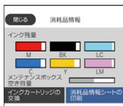
[消耗品情報シートの印刷] を選択すると、インクカートリッジとメンテナンスボックスの状態と、商品名が印刷できます。消耗品の購入時に印刷すると便利です。
