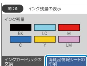
【消耗品情報シートの印刷】を選択すると、インクカートリッジの状態と、商品名が印刷できます。消耗品の購入時に印刷すると便利です。
