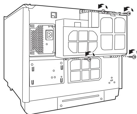
**7** ネジを外して、背面プリンターカバーを外します。
