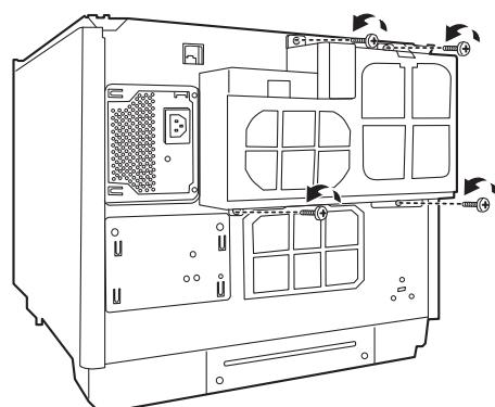
7 ネジを外して、背面プリンターカバーを取り外します。
