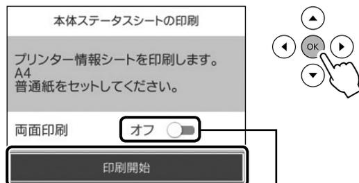
両面で印刷するときには、[両面印刷]にカーソルを合わせ、OK ボタンを押して [オン] にします。
