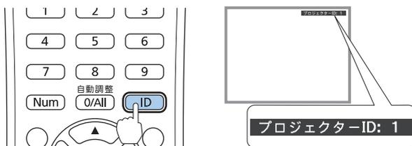
リモコンの【ID】ボタンを押しながら、投写画面に表示されたIDと同じ番号のボタンを押します。【ID】ボタンを押しながら【0/All】ボタンを押すと、プロジェクターIDの設定に関わらず、すべてのプロジェクターを操作できるようになります。
