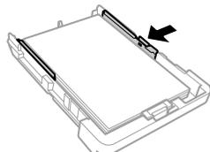
**4** 用紙が図で示した線の高さを超えていないことを確認する
