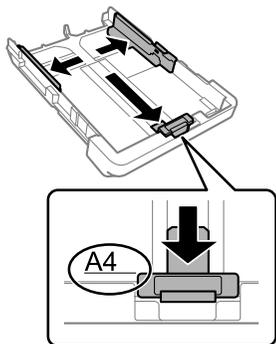
印刷する面を下にして縦長にセットする
