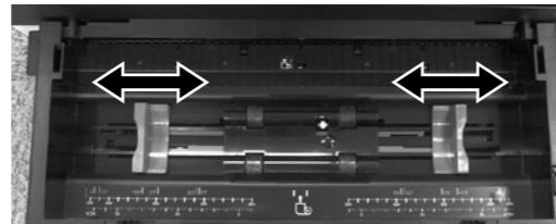
調整邊緣導引器位置以匹配滾筒的寬度。
