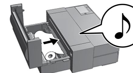
用雙手拿住滾筒紙，將其先端慢慢插入打印機進紙槽中，直到聽到嗶聲。
