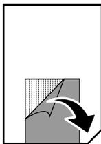
**3** クリーニングシートのコーナーカット（切り欠け部）を右下にして、プリンターにセットし用紙ガイドを用紙の側面に合わせる
