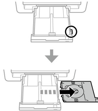
**6** 印刷する面を上にして、ディスクトレイにディスクをセットする
