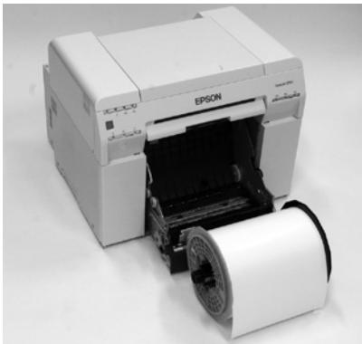
スピンドルユニットを上図の向きにして、ロールペーパー供給部の手前に置きます。
