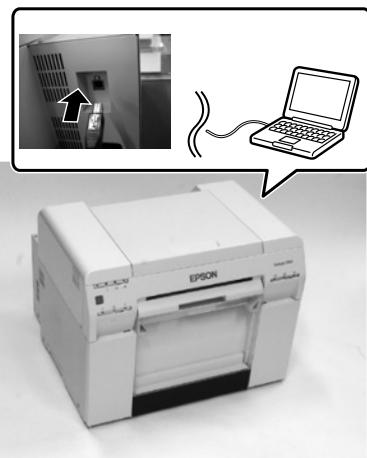
本製品の電源を切り、プリンターとコンピューターにUSBケーブルを接続します。
