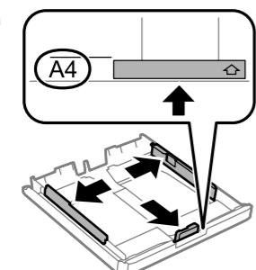
④印刷する面を下にして、手前の用紙ガイドに合わせてセットする
