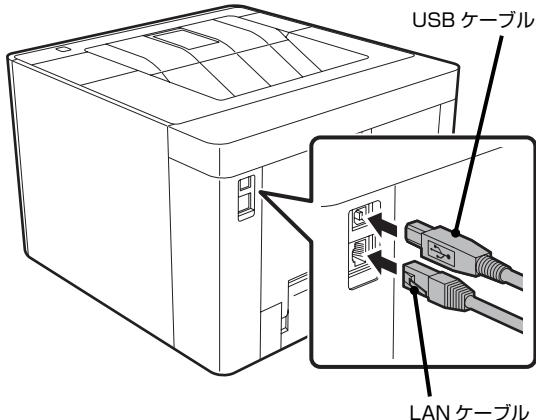
3 ケーブルの一方を、LAN 接続の場合はハブに、USB 接続の場合はコンピューターに接続します。
