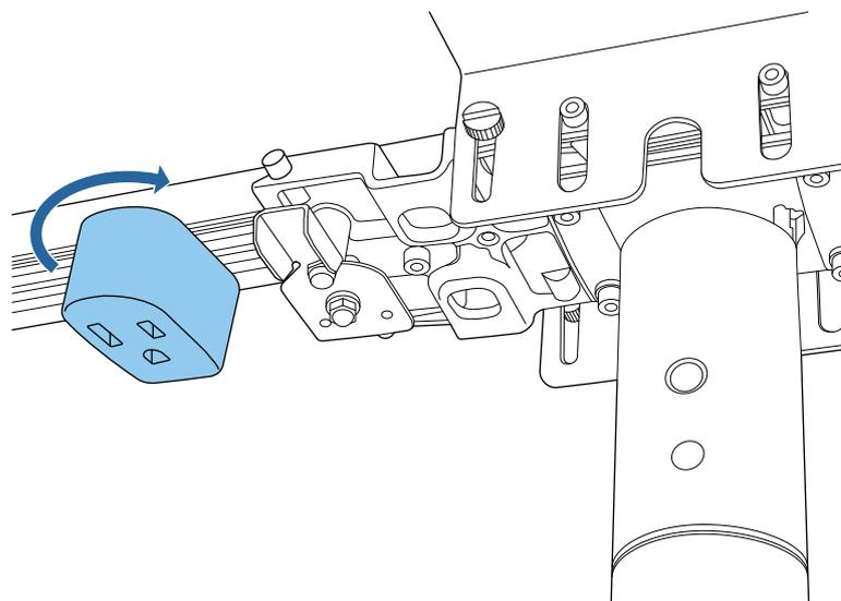
3 プロジェクターに同梱の電源ケーブルを、プロジェクターの電源端子に接続する。
