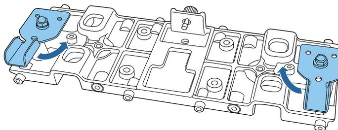
3 プロジェクターを取り付ける配線ダクトに、配線ダクトユニットを差し込む。
