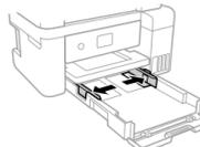
③ 印刷する面を下にして、カセットの奥に突き当ててセットする
