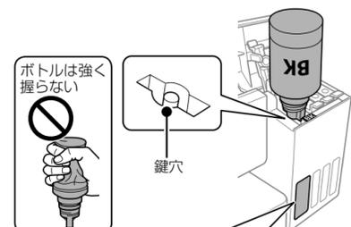
ボトルを正しい色の注入口に挿すと、インクの注入が自動で始まり、40秒ほどで上限線止まります。
