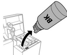
**重要** インクボトルをタンクに挿したままにしないでください。ボトルの破損やインク漏れの原因になることがあります。
