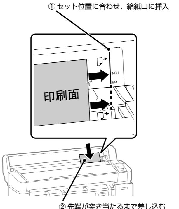
**重要** 用紙は必ず縦長にセットしてください。横長にセットすると印刷品質が低下することがあります。
