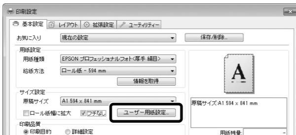
プリンタードライバーの【基本設定】画面で【ユーザー用紙設定】をクリックします。
