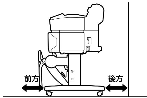
ボード紙は、本機の前方と後方に用紙を突き出して印刷します。必要なスペースの目安は、下表の通りです。
