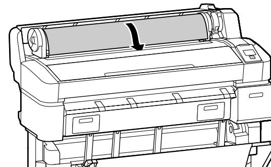
ロール紙の先端を給紙口に挿入していくと、「ピッピッ」と鳴ります。
