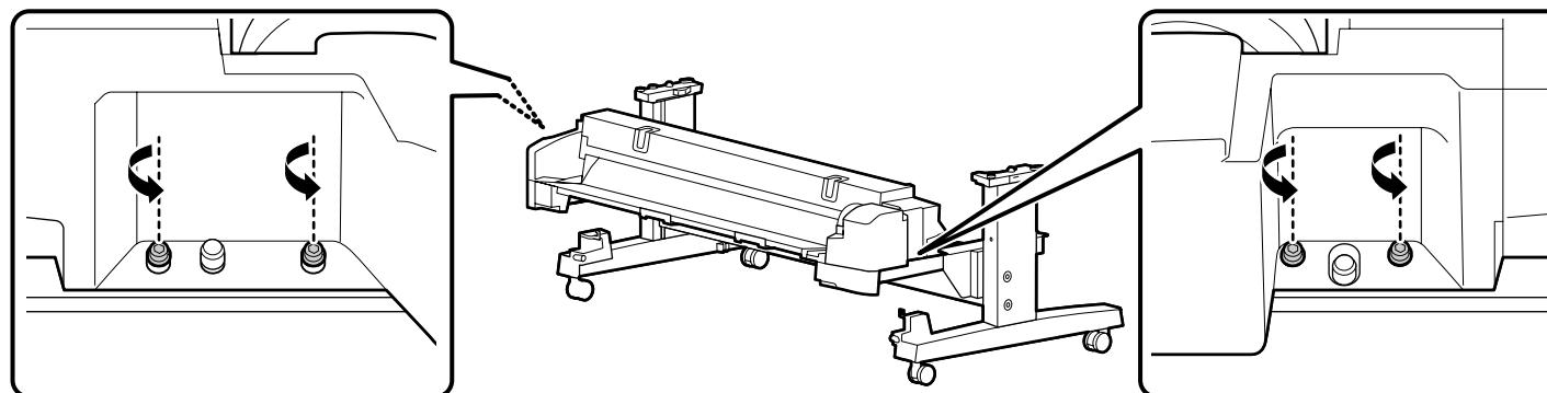
ネジを 1 回転以上緩めて仮締め状態にします。
