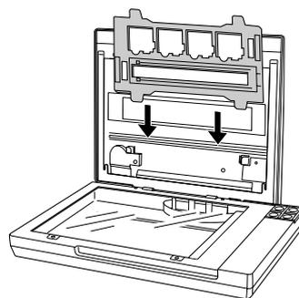
② フィルムホルダーを上から差し込むようにして収納します。
